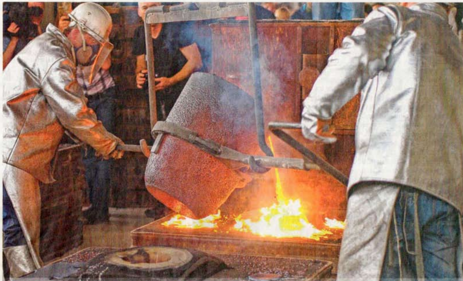
Mit glühend heißer Bronze wird das neue Mendelssohn-Denkmal in Form gegossen. Manfred Rodekirchen und Alexander Adalbert Paul arbeiten in Feuerschutzanzügen.
